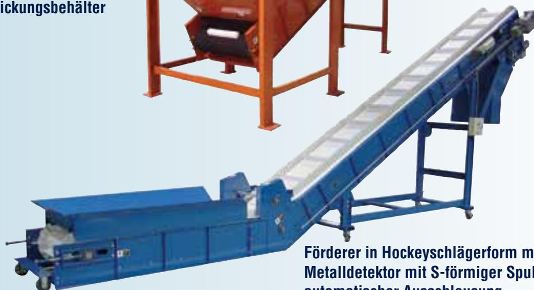
**Förderer in Hockeyschlägerform mit Metalldetektor mit S-förmiger Spule und automatischer Ausschleusung**
