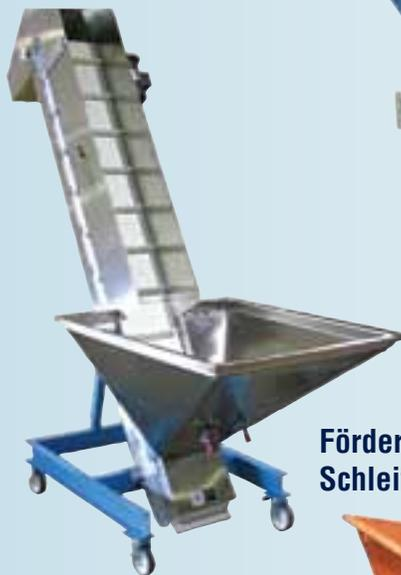
**Förderer zum Beschicken von Schleifmaschinen für leichte Lasten**
