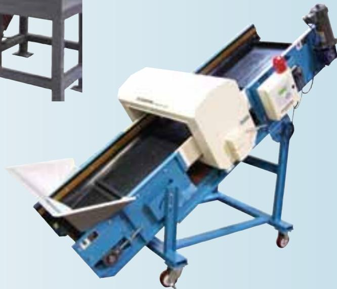
**Förderer zur Beschickung von Zerkleinerern mit C-Spulen-Metalldetektor und mobiler Basis**
