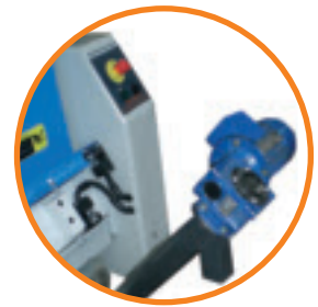
Detail: Vertical suction screw Particolare: Coclea di estrazione verticale
