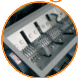
Detail: Grinding chamber Particolare: camera di macinazione
